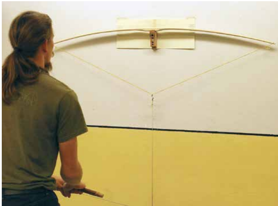
Mikke Reinikainen tilleröimässä. Jouta jännitetään tässä koukkupäisen narun avulla, joka kulkee pylpyrjän kautta vetokapulaan.
