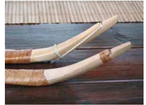
Staattisilla vastakaarilla varustettuja saamelaisjousia. Taipuva osa on kääritty koivuntuoheen, joka suojaa liimasaumaa kosteudelta.
