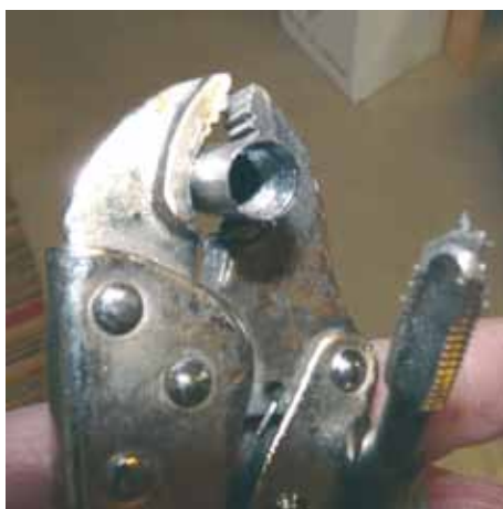
Kartion pintaan tulee kierteet, jotka parantavat kiinnipysymistä moninkertaisesti.
