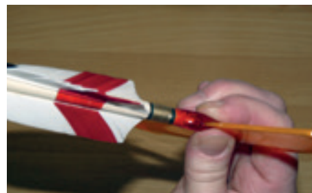
Kuumennetun nokin säätö puristamalla muovinpalaa vasten.
